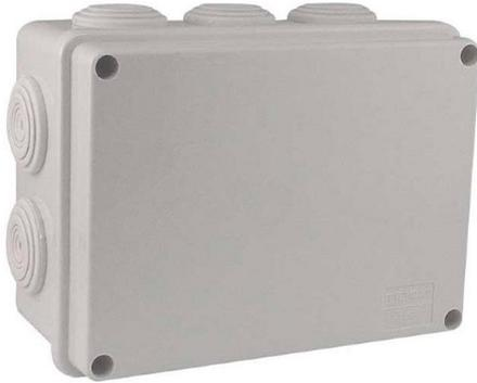
Nivel de protección IP65, fabricación en plástico ABS, perforaciones traseras para montaje a pared. Temperatura de operación: - 20 a 60° C, ideal para instalación de equipo en exterior. Se recomienda el uso de prensaestopas para salida de cableado. Dimensiones: 10X15X8cms
