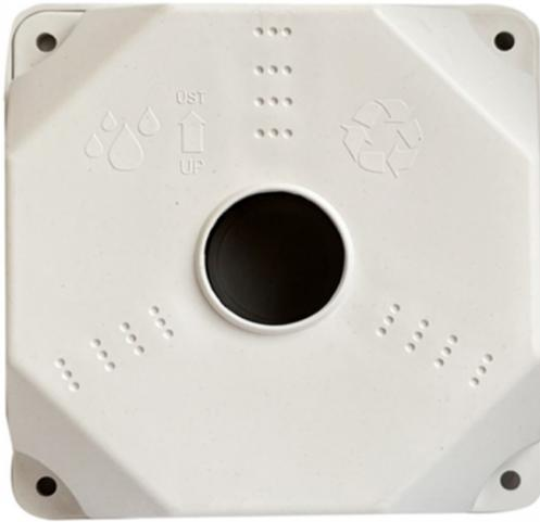
Nivel de protección IP65, fabricación en plástico ABS, perforaciones traseras para montaje a pared. Temperatura de operación: - 20 a 60° C, ideal para instalación de equipo en exterior. Se recomienda el uso de prensaestopas para salida de cableado. Dimensiones: 10X10X5cms
