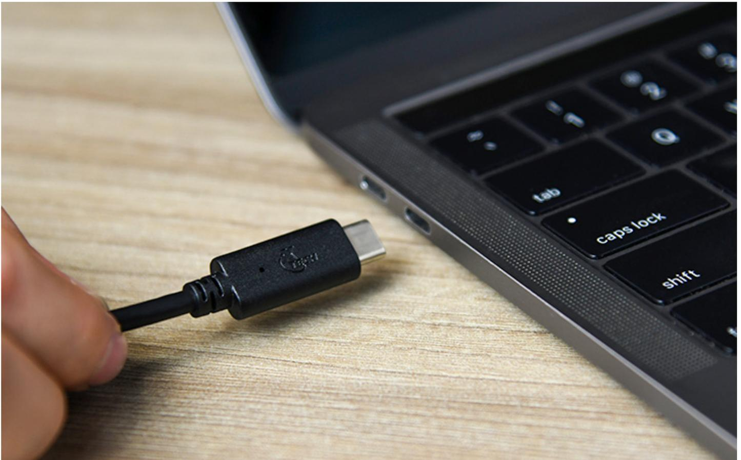
El diseño reversible tipo C simplifica la conexión, ya que el cable se puede conectar en cualquier dirección
