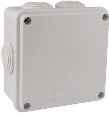
Nivel de protección IP65, fabricación en plástico ABS, perforaciones traseras para montaje a pared. Temperatura de operación: - 20 a 60° C, ideal para instalación de equipo en exterior. Se recomienda el uso de prensaestopas para salida de cableado.
